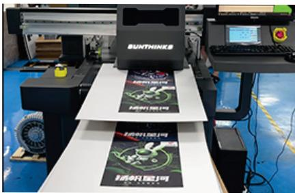
Impressora totalmente digital de passagem única, método de impressão direta, sem necessidade de criação de chapas, aplicação flexível, pode imprimir assim que a máquina for ligada.
