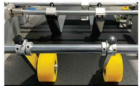
A correia de alimentação patenteada possui uma função automática de correção de desvio e trabalha em conjunto com a função de sucção da plataforma de impressão para garantir uma posição de impressão precisa.
